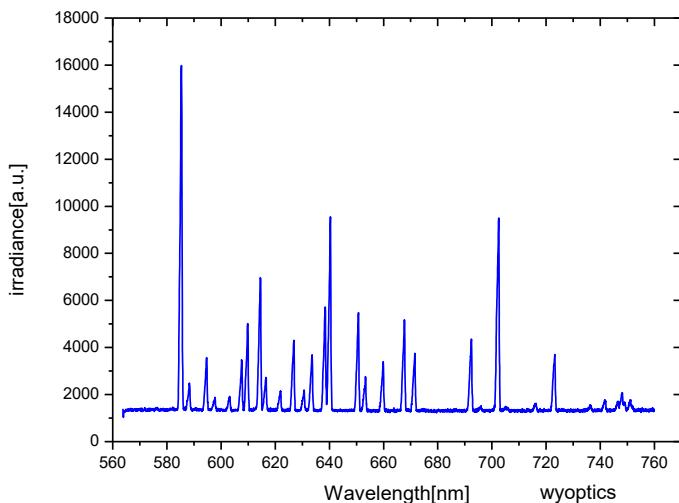
它可以给出从540 nm到754 nm稳定的氘灯的特征谱线。主要谱线和结构包括它们的相对强度都贴在光源的表面上。通过标准SMA905或者FC/PC 接头，该光源可以快速地与光纤连接，因此可以非常容易地对光纤光谱仪进行波长定标。此外，还有适用于其他波段的波长定标光源，如汞氩灯 HG-1 (253.6-1704nm) , XE-1(916-1984nm)。
